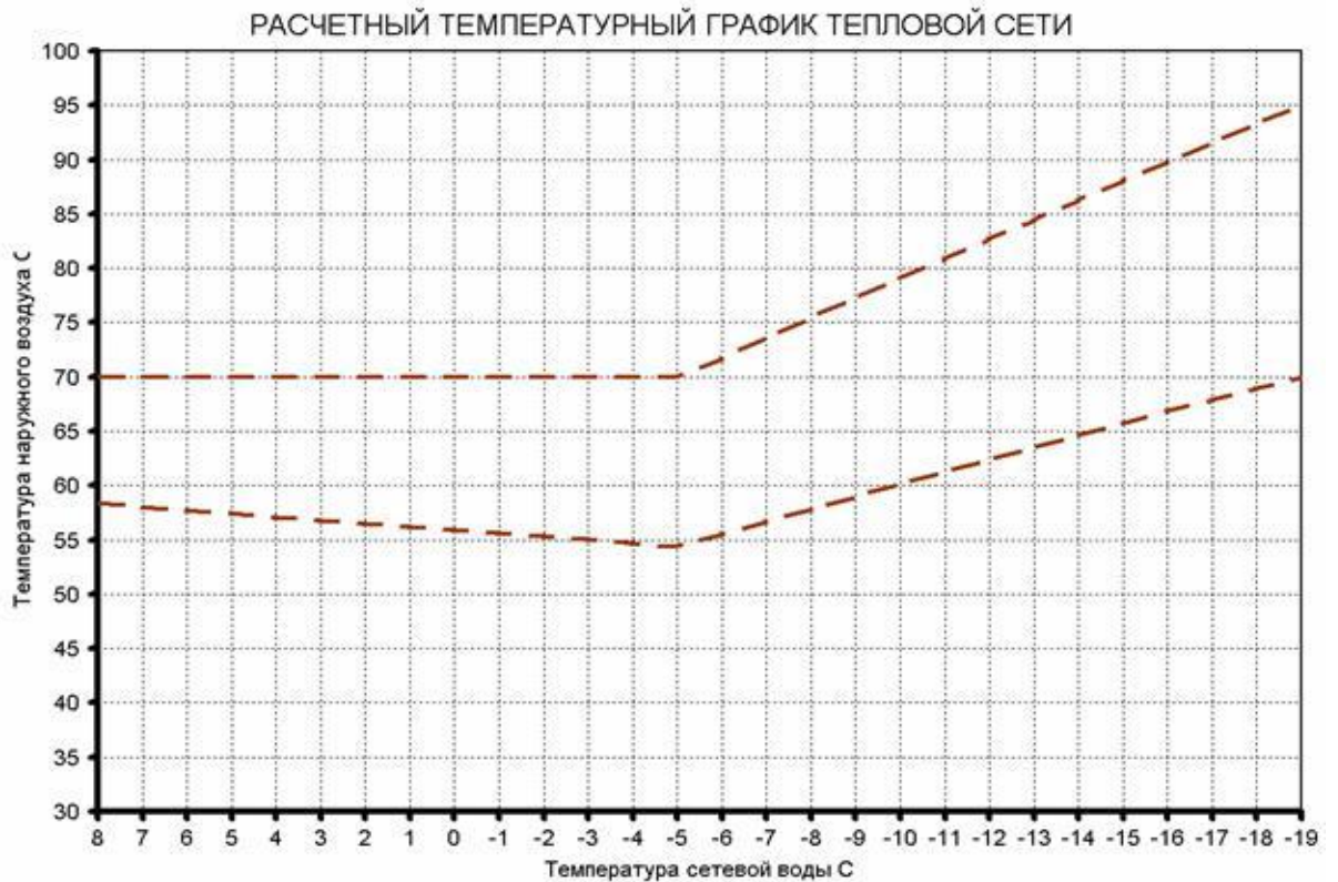
Рисунок 3. Температурный график 95 - 70 °С для отопления с ГВС.
