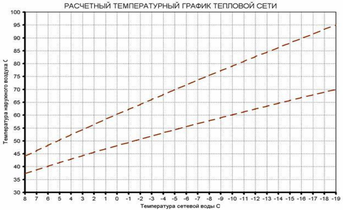
Рисунок 2. Температурный график 95 - 70 °С для отопления.
